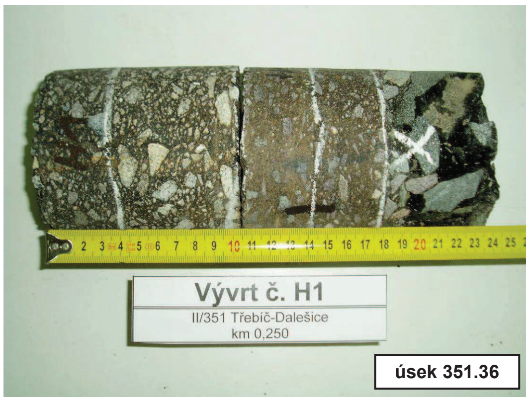
Foto č. 1 – Detail vývrtu č. 1H
