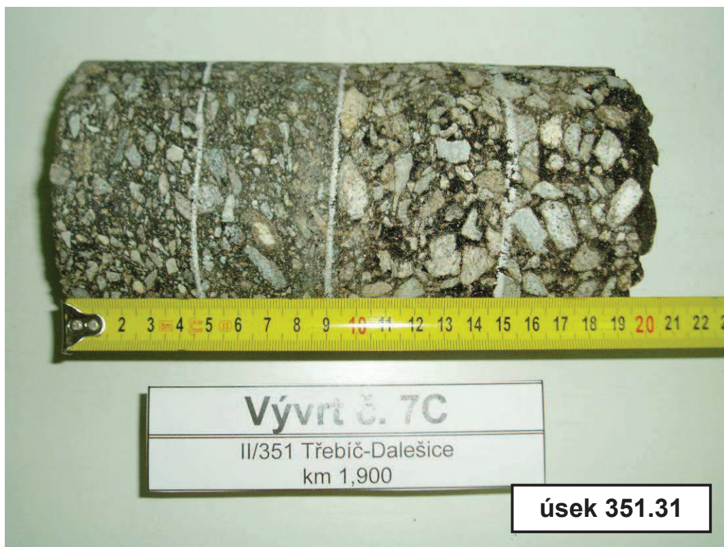
Foto č. 7 – Detail vývrtu č. 7C
