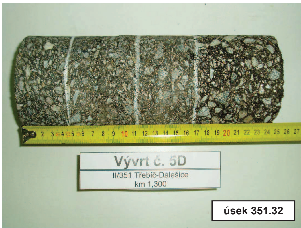
Foto č. 5 – Detail vývrtu č. 5D
